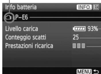
Modello della batteria o tipo di presa domestica utilizzata.
